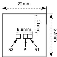
Fig. 2. Testchip floorplan.
